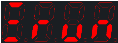
3#水泵运行(不使用互感器)
