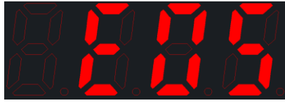
故障代号显示(外部电源故障)
