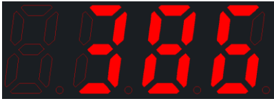
工作时显示 Uab 电压值（单位：V）
